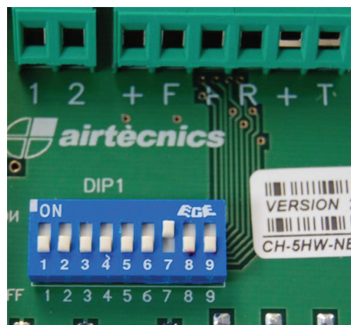
Rys. Przełącznik 7 w pozycji ON - bez magnetycznego wyłącznika krańcowego.
