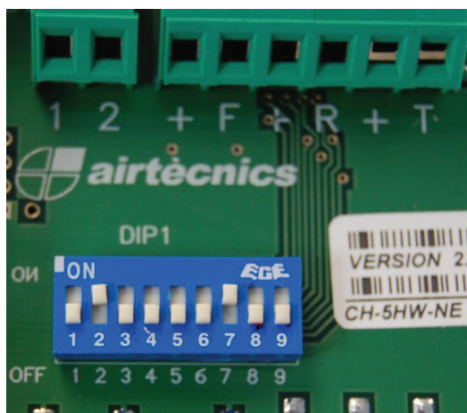
Rys. Przełącznik 2 i 7 w pozycji ON - z magnetycznym wyłącznikiem krańcowym.
